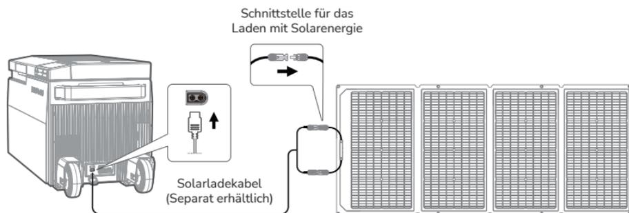
Dieses Produkt unterstützt das Aufladen mit Solarenergie und unterstützt das Aufladen des Akkupacks EFBX100-EB (fakultativ) mit einer maximalen Leistung von 180 W.
