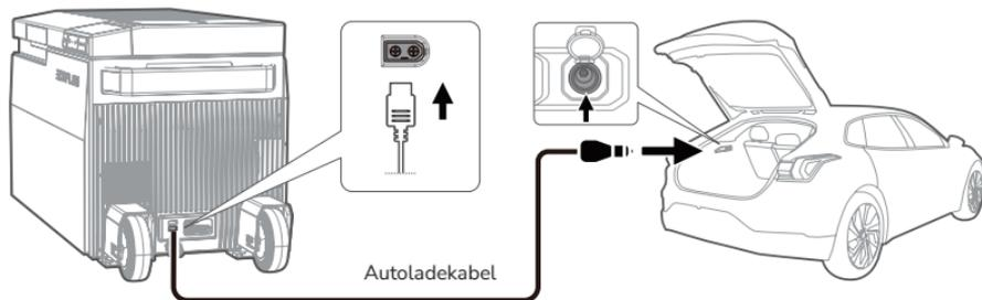
Dieses Produkt unterstützt das Laden im Auto über den 12 V/24 V-Autoladeanschluss und lädt den angeschlossenen EFBX100-EB-Akkupack (fakultativ) mit einem maximalen Strom von 10 A.
